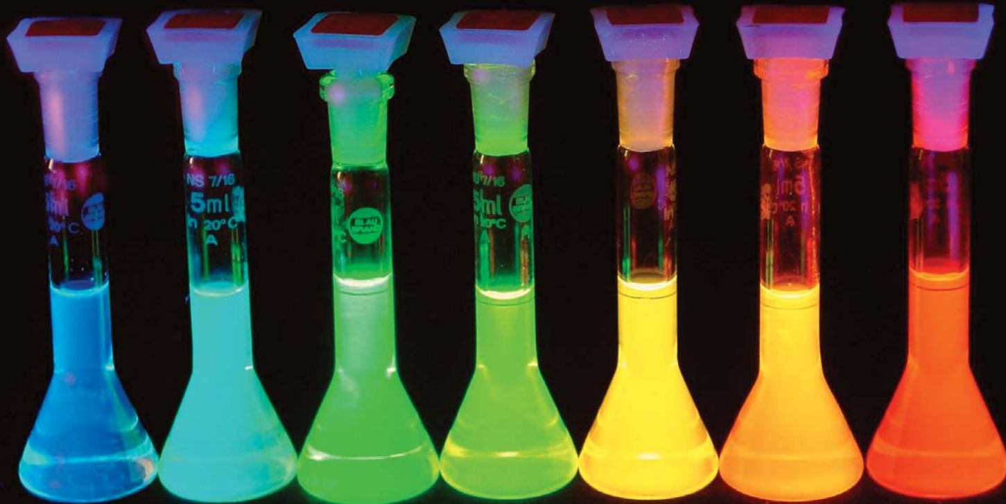
Bild: Die Lumineszenz von kolloidalen CdSe/ZnS-Nanopartikeln ist abhängig von der Partikelgröße (links: ~2nm, rechts: ~6nm) © 2015 Dmitri V. Talapin
