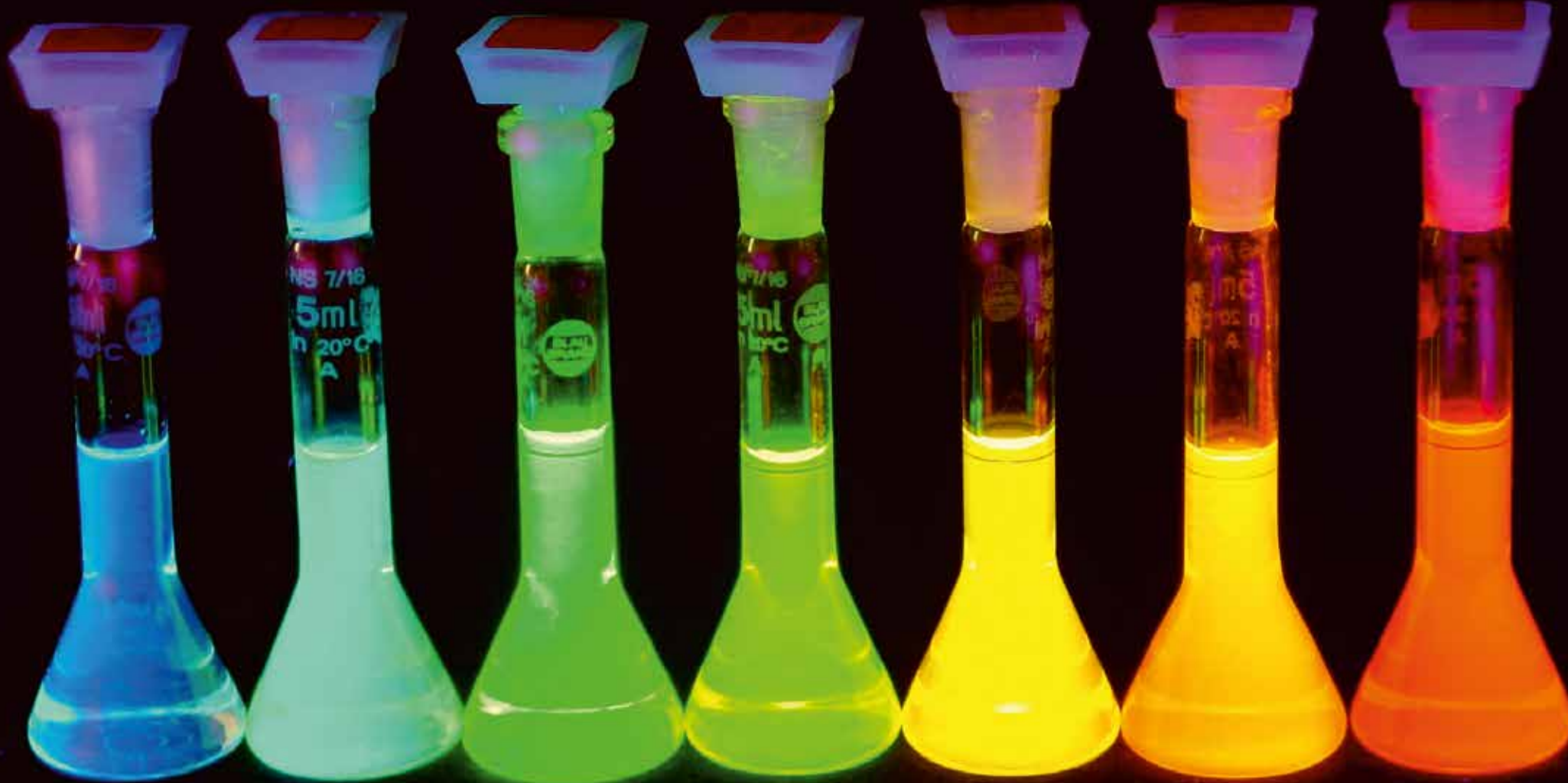
Bild: Die Lumineszenz von kolloidalen CdSe/ZnS-Nanopartikeln ist abhängig von der Partikelgröße (links: ~2nm, rechts: ~6nm) © 2017 Dmitri V. Talapin
